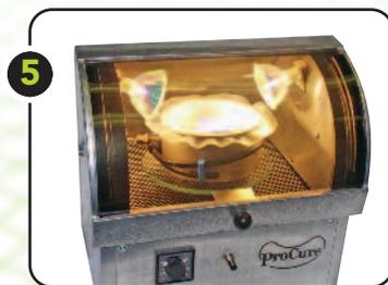
5 Placez le EZ VAC à l'intérieur de l'appareil à photopolymériser.
